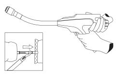
При необходимости, придерживайте регулирующую рукоятку для предотвращения втягивания троакара внутрь аппарата, при присоединении лапароскопическим доступом.
